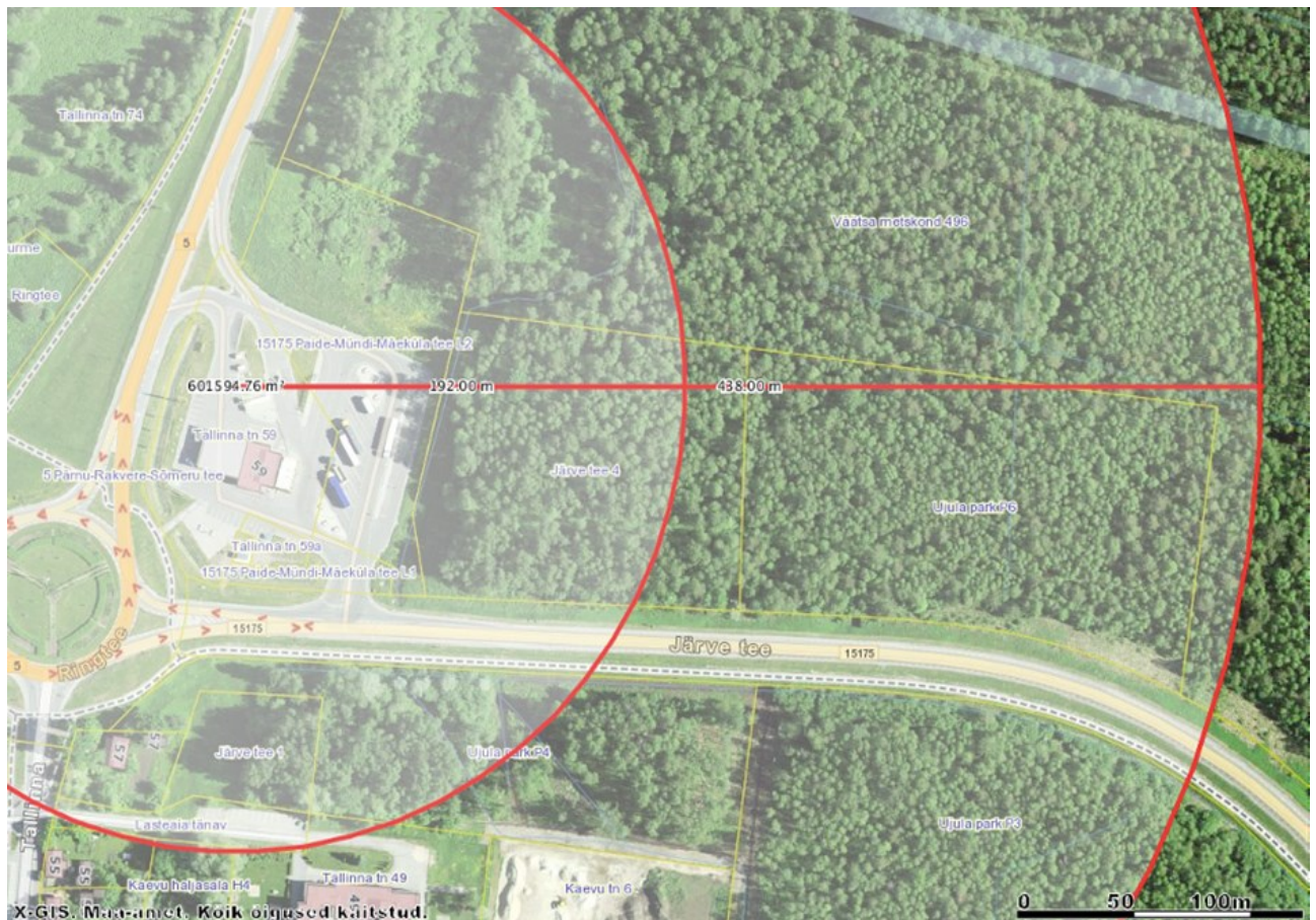
Joonis 3. AS Olerex tankla bensiinitsisterni BLEVE ohuala ehitistele: 192 m ja kaitsmata inimestele: 438 m. Allikas: geoportaal.maaamet.ee .
